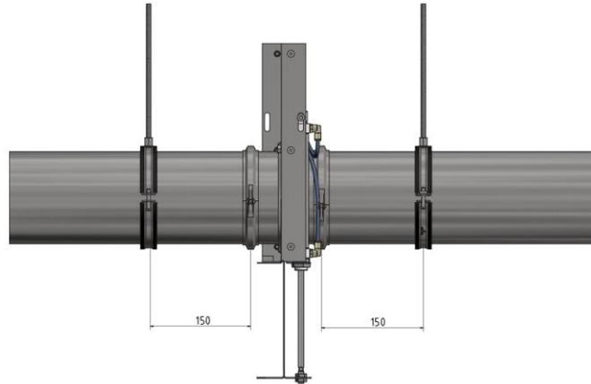
2) Die Erdung des elektro-pneumatischen Magnetventils (110 V AC und 230 V AC) hat ordnungsgemäß zu erfolgen.
